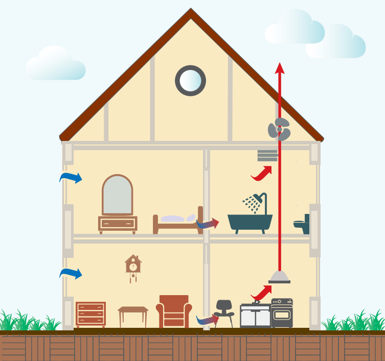
Bild 10: Ventilatorgestützte Lüftung: ALD und Abluftanlage (rot = Abluft; blau = Zuluft)
